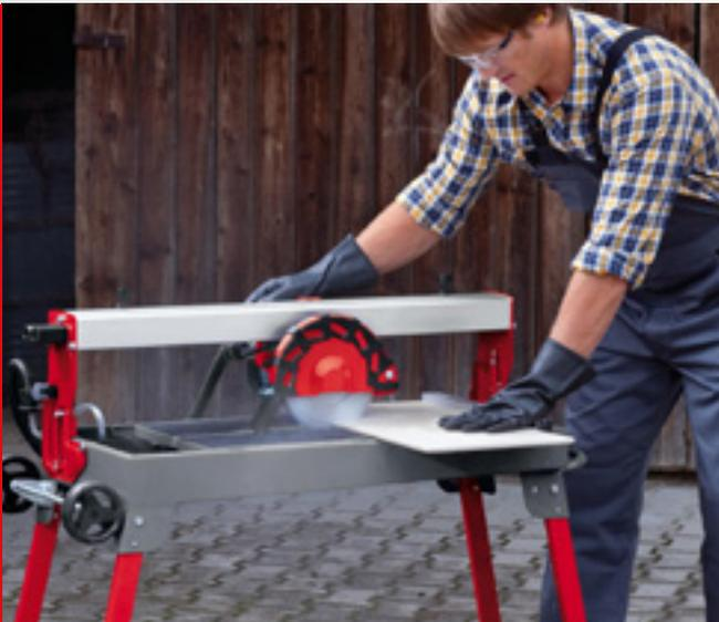
Le coupe carrelage radial TE-TC 620 U est une machine performante et de haute qualité pour la découpe rapide et précise de vos carreaux au mur et vos carrelages. Son moteur de 900 W dispose d'une puissance suffisante pour entraîner facilement le disque diamanté turbo de 200 mm de diamètre, même dans les matériaux les plus difficiles à couper.
